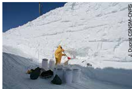
▲ Научная станция Concordia в Антарктиде. В многометровом снежном покрове вырыта траншея, из стен которой берутся образцы для анализов на предмет наличия в снеге пылевых частиц.
